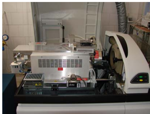
Fig. 1 – Spectrometrul de masă cuplat inductiv cu plasmă SCIEX Perkin-Elmer Elan DRC II
