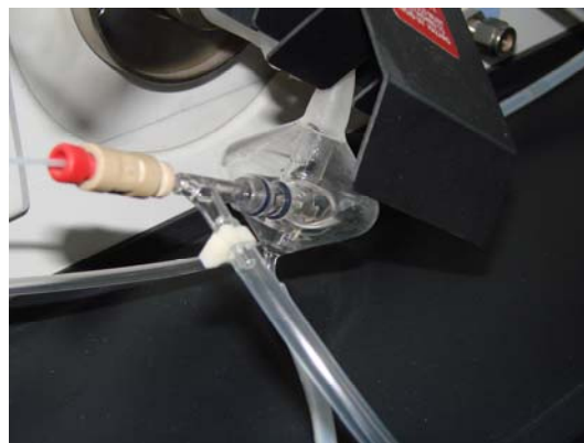
Fig. 2 – Nebulizatorul tip Meinhard și camera ciclonică unde se formează aerosoli
