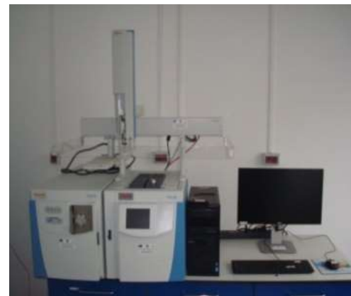
Sistem GC TRACE 1310 cuplat cu spectrometru de masă triplu cuadрупol
