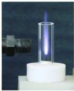
Figura 1. Fotografii ale: (a) echipamentului spectrometric miniaturizat (ansamblu al componentelor); (b) tortei in care se produce microplasma cuplata capacitiv, de mica putere, avand consum scazut de Ar; (c) unui dispozitiv de prelevare pasiva bazat pe tehnica gradientilor de difuzie in filme subtiri
